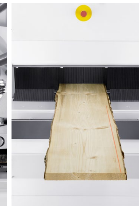
Láser para la visualización del corte: ver que se corta
