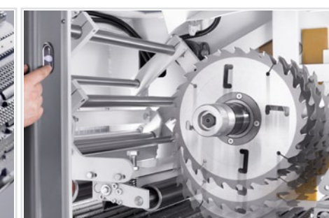
Ajuste eléctrico de la altura del eje de sierra: alto confort en el manejo
