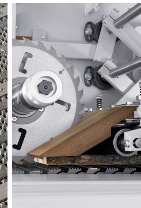
Zapato de presión: perfecta calidad de corte también en maderas cortas
