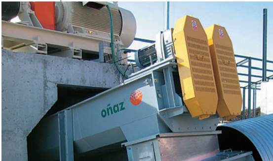
Tornillo sinfín doble para evacuación de material de una astilladora de tambor. Double screw conveyor for evacuation of material from a drum chipper.
