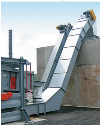
Transportadores de cadena para evacuar diferentes fracciones de material de un proceso de cribado
